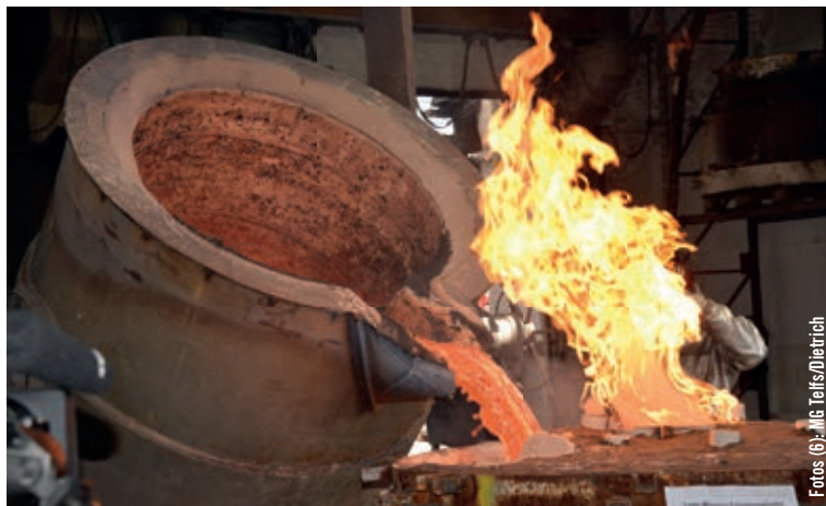
1.100 Grad Celsius hatten die – inklusive Reserve – 12 Tonnen flüssige Bronze, die in die gewaltige Glockenform strömten. Darin steckte auch viel Material der eingeschmolzenen alten Glocke.
